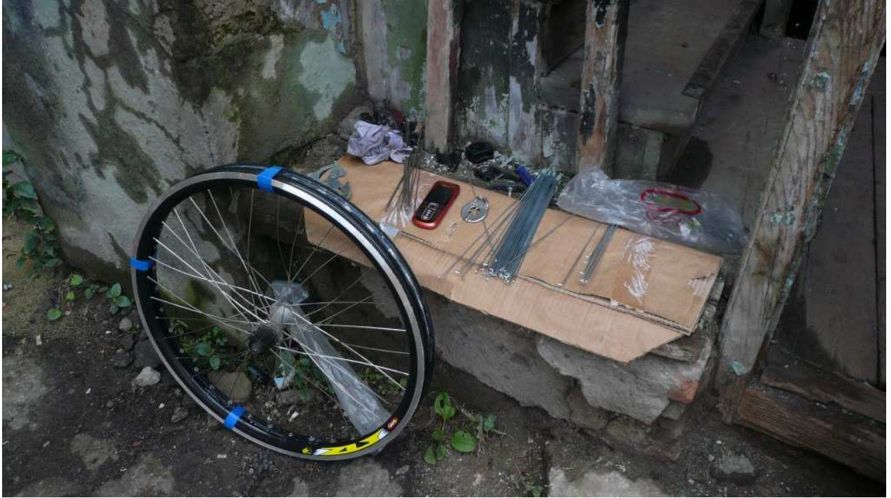
Umspeichen auf die neue Felge
